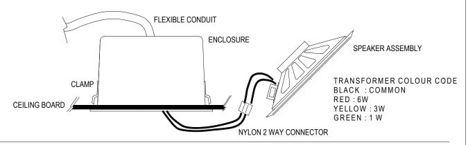
STEP 4: INSTALL THE SPEAKER AND BAFFLE ASSEMBLY TO THE ENCLOSURE
